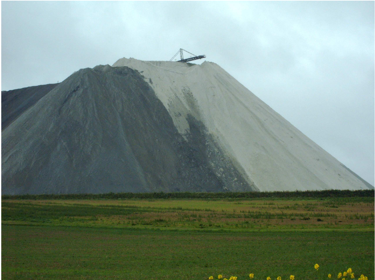
Abbildung 2 zeigt eine Ansicht der Halde. Rechts die weißen Steinsalz-Rückstände aus der Kaliumaufbereitung, links die schwarzen REKAL-Abfälle.
