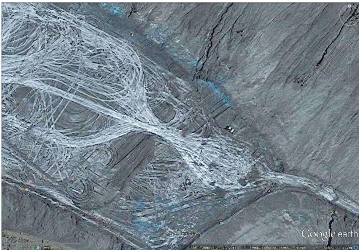
Abbildung 5 – Ausblühungen von Kupfersalzen (blau) und Erosionsrinnen auf der REKAL-Abdeckung der Kalihalde Sigmundshall bei Wunstorf.
