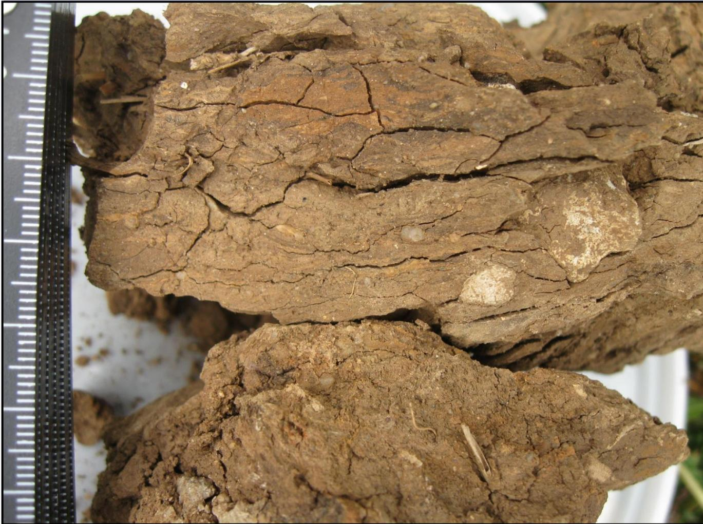
Plattengefüge als Indikator schwerer Strukturschäden durch Bodenverdichtung (Jörg Zausig, 2014, GeoTeam GmbH)
