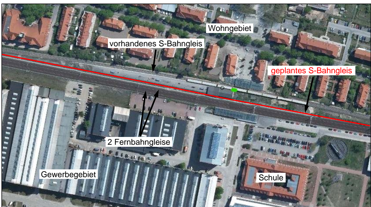
Bild 17: Bau eines zweiten S-Bahngleises (Quelle: EBA-Explorer)
