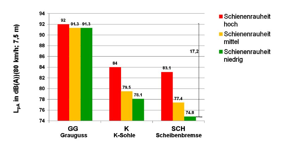
Quelle: Emissionsdatenbank sonRAIL CH, Betonschwelle, Schiene UIC 60
