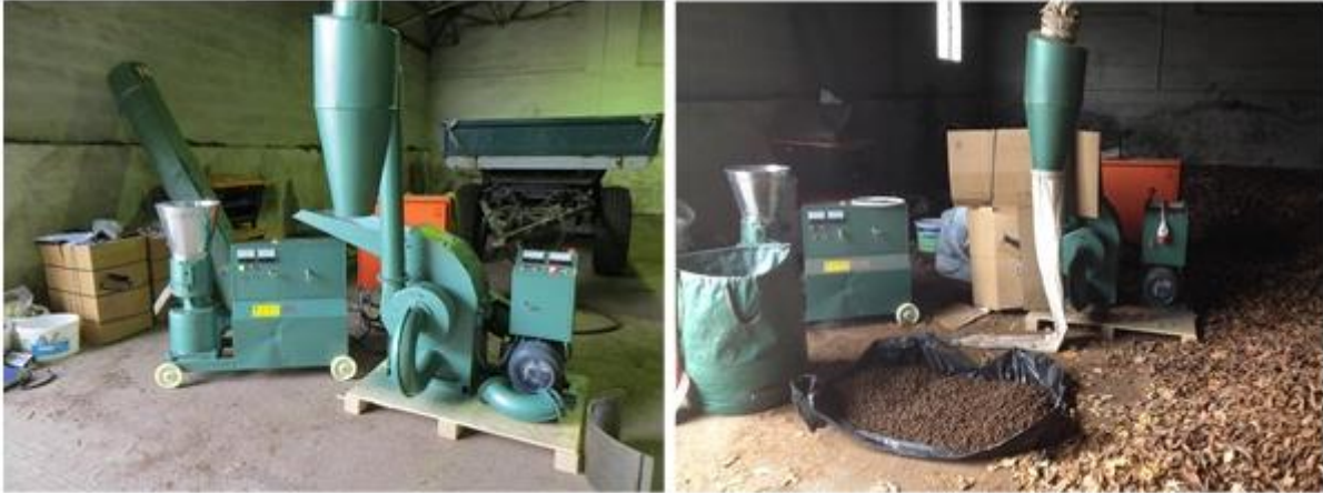
Abb. 11: Pelletierungsanlage und erste erzeugte Laubpellets
